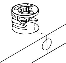
Debes insertar las cajas minifix con la flechita apuntando hacia la perforación que hay en el borde de la pieza.
