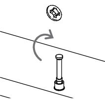
Luego de unir las piezas, debes girar 180° las cajas minifix con un destornillador de estrella para ajustar y asegurar el ensamble.
