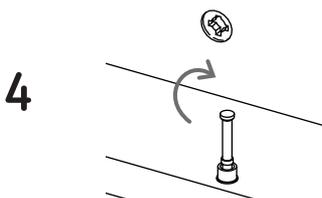
Luego de unir las piezas, debes girar 180° las cajas minifix con un destornillador de estrella para ajustar y asegurar el ensamble.
