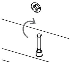
Luego de unir las piezas, debes girar 180° las cajas minifix con un destornillador de estrella para ajustar y asegurar el ensamble.
